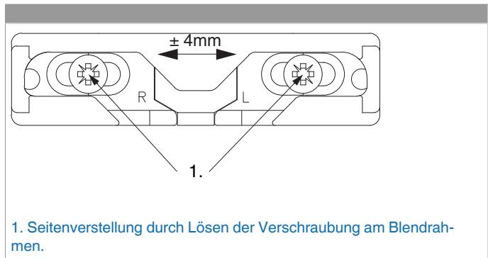
1. Seitenverstellung durch Lösen der Verschraubung am Blendrahmen.
