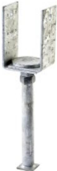
Die höhen- und seitenverstellbaren PVD Stützenfüße können für alle Holzbreiten zwischen 80-120/ 120-160 mm verwendet werden. Die PVD sind zum Einbetonieren.
