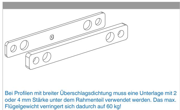
Bei Profilen mit breiter Überschlagsdichtung muss eine Unterlage mit 2 oder 4 mm Stärke unter dem Rahmenteil verwendet werden. Das max. Flügelgewicht verringert sich dadurch auf 60 kg!
