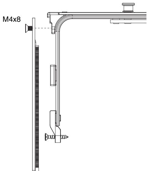
**WICHTIG** - Nutgrundverschraubung vor Stützbockverschraubung
