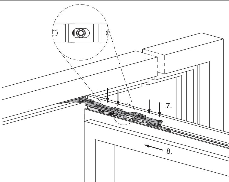
7. Drehbandarm auf den Drehbandstulp drücken.
