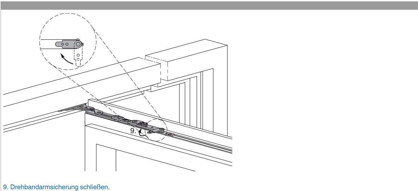
9. Drehbandarmsicherung schließen.
