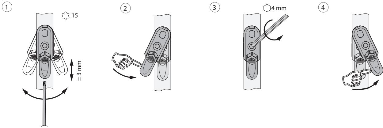
1. Ausschwenken und Höhenverstellung der Hebesicherung.
