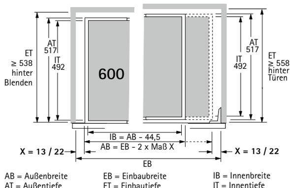
AB = Außenbreite    EB = Einbaubreite    IB = Innenbreite
