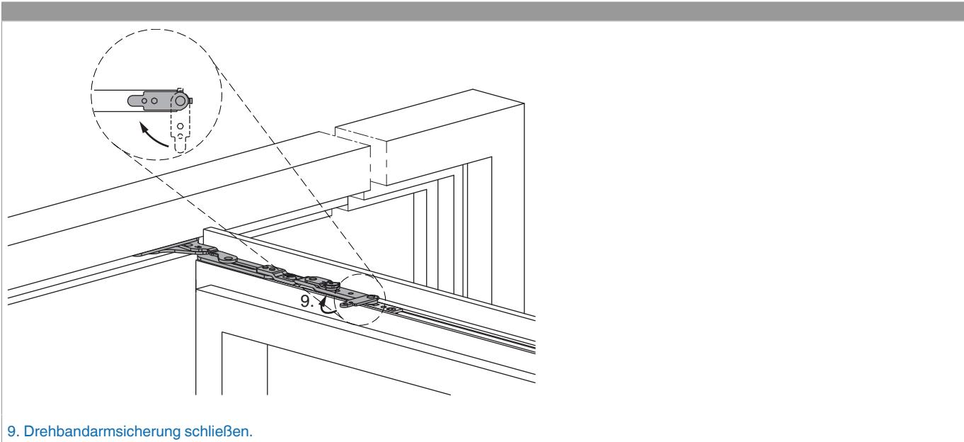
9. Drehbandarmsicherung schließen.
