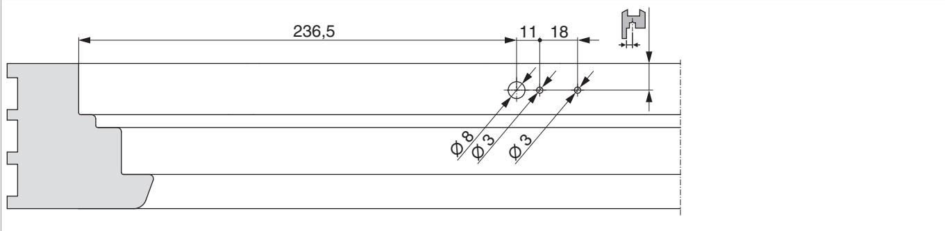
Bohrung Kabeldurchgang - Einbau mit Eckumlenkung kurz, senkrecht
