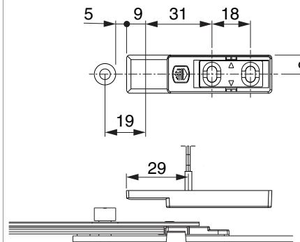
Position Kontaktgeber bei verriegeltem Beschlag
