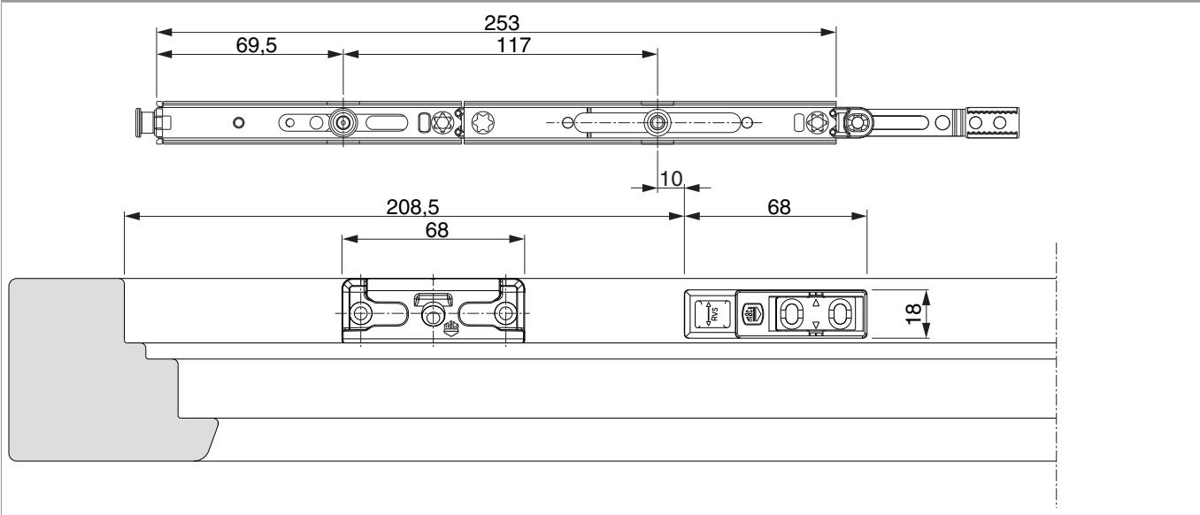
Position Kontaktgeber bei entriegeltem Beschlag
