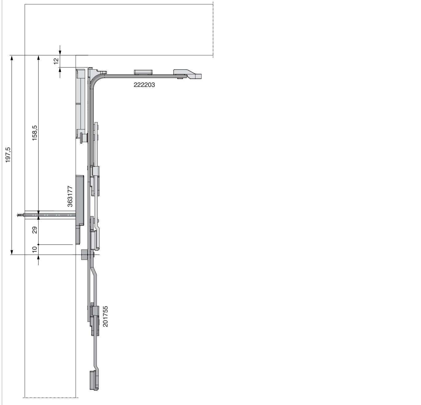
Bohrung Kabeldurchgang - Einbau mit Eckumlenkung Standard, waagrecht
