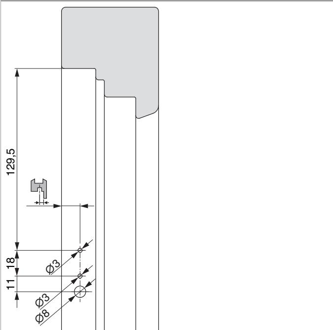
Bohrbild für Reedkontakt - Einbau mit Eckumlenkung Standard, waagrecht
