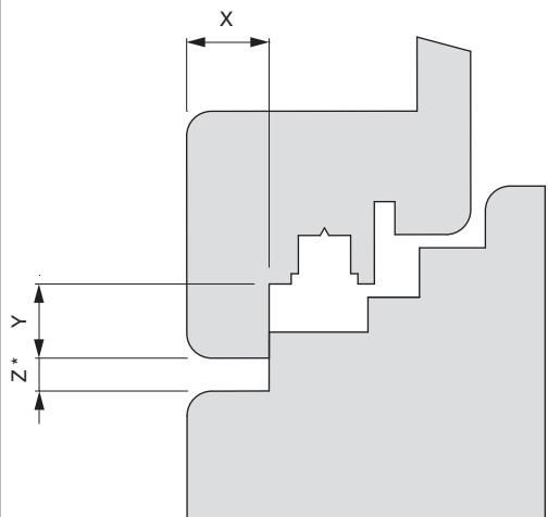
\* Mindestfreimaß ist von der Ausführung des Überschlags (Radius, Lackstärke, ...) abhängig. Die Werte für Z in der Tabelle sind ohne Berücksichtigung von Toleranzen. Wir empfehlen immer vorab eine kundenseitige Überprüfung des verwendeten Profils!
