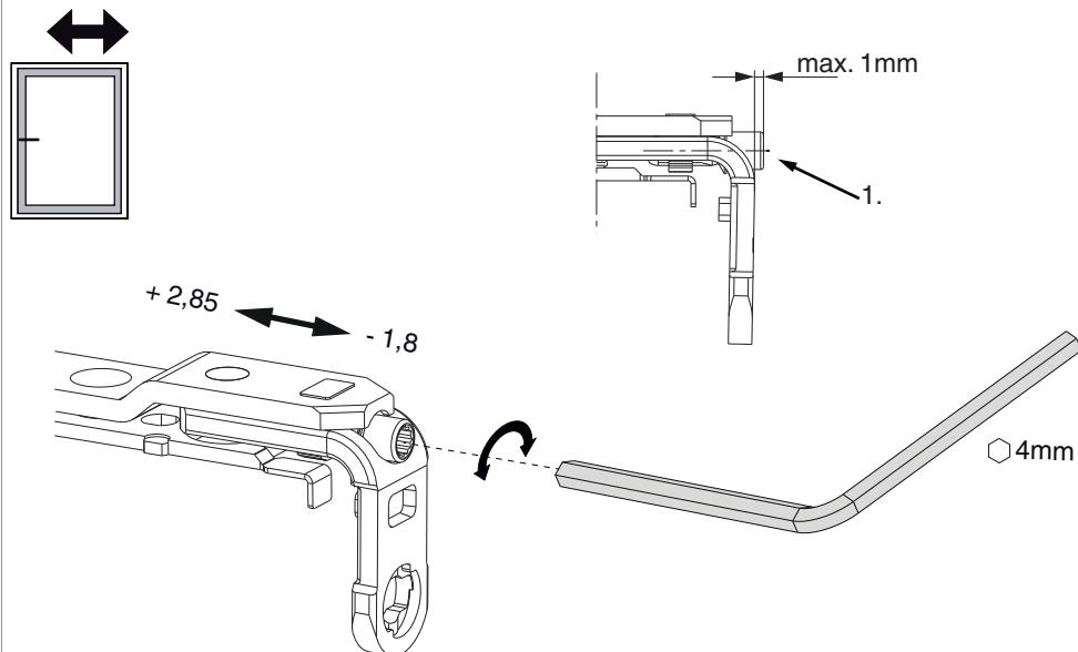
1. Beim Absenken des Flügels darauf achten, dass die Schraube nicht komplett herausgeschraubt wird. Der Schraubenkopf darf maximal 1 mm vorstehen!
