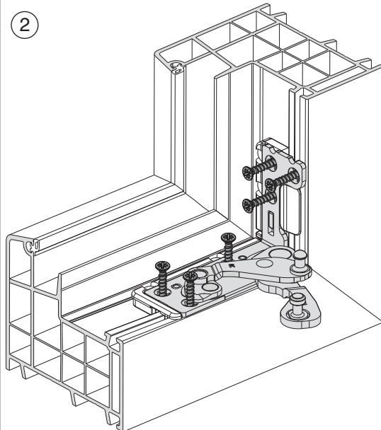
2. Anschließend Eck- und Scherenlager mit PVC-Beschlagschraube mindestens 4 x 30 mm (Vollgewinde) verschrauben.
