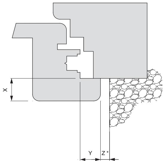
\* Mindestfreimaß ist von der Ausführung des Überschlags (Radius, Lackstärke, ...) abhängig. Die Werte für Z in der Tabelle sind ohne Berücksichtigung von Toleranzen. Wir empfehlen immer vorab eine kundenseitige Überprüfung des verwendeten Profils!
