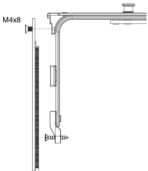
**WICHTIG** - Nutgrundverschraubung vor Stützbockverschraubung durchführen!
