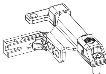
1. Scherenlagerstiftsicherung bis zum Anschlag aufschieben.
