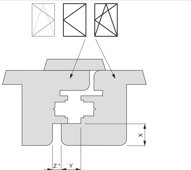
\* Mindestfreimaß ist von der Ausführung des Überschlags (Radius, Lackstärke, ...) abhängig. Die Werte für Z in der Tabelle sind ohne Berücksichtigung von Toleranzen. Wir empfehlen immer vorab eine kundenseitige Überprüfung des verwendeten Profils!
