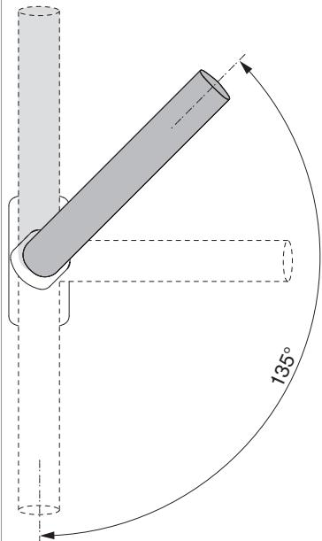
Fenstergriff mit 135° Raststellung für Spaltlüftung und Kippstellung
