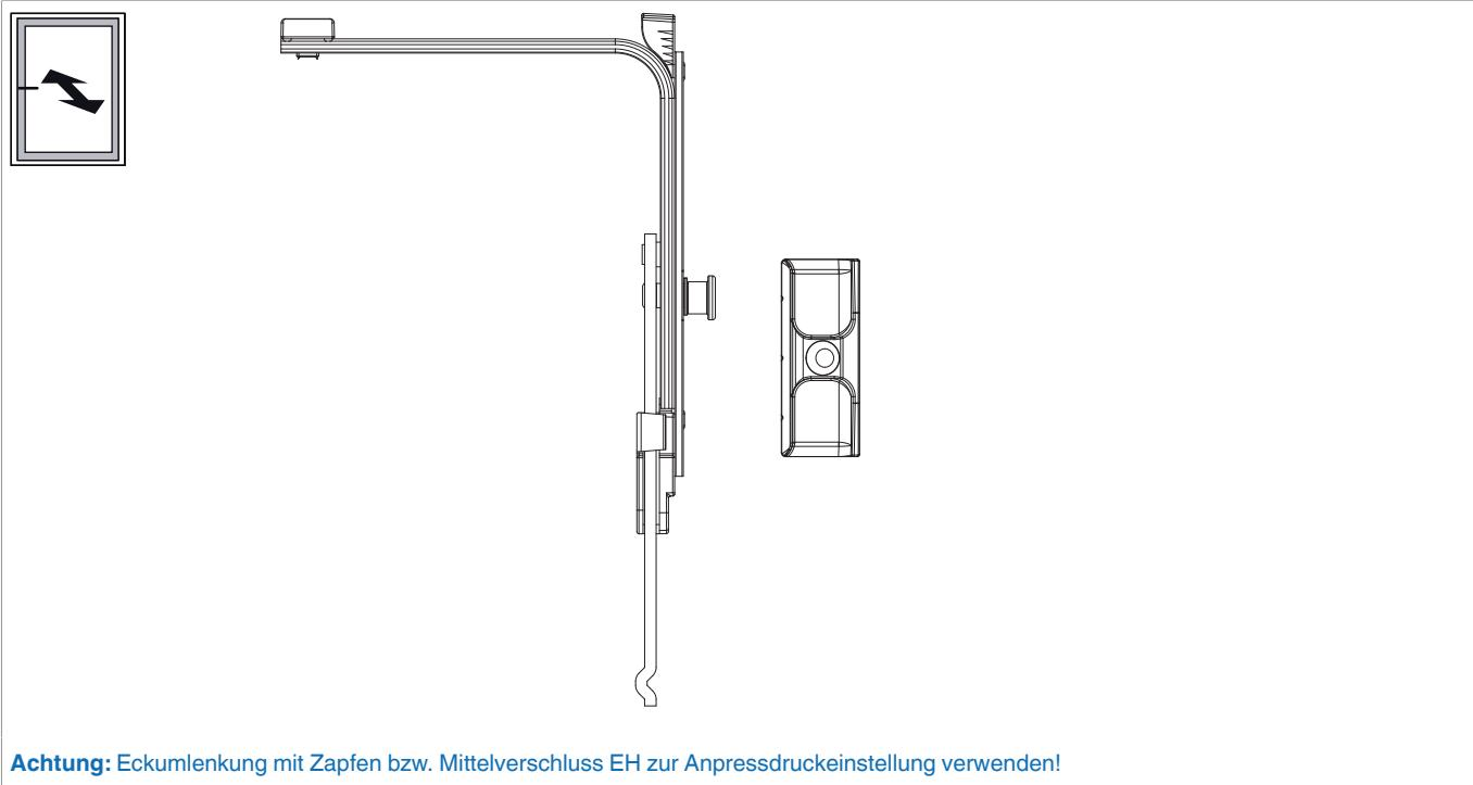
Achtung: Eckumlenkung mit Zapfen bzw. Mittelverschluss EH zur Anpressdruckeinstellung verwenden!
