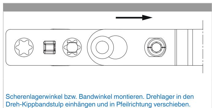
Scherenlagerwinkel bzw. Bandwinkel montieren. Drehlager in den Dreh-Kippbandstulp einhängen und in Pfeilrichtung verschieben.
