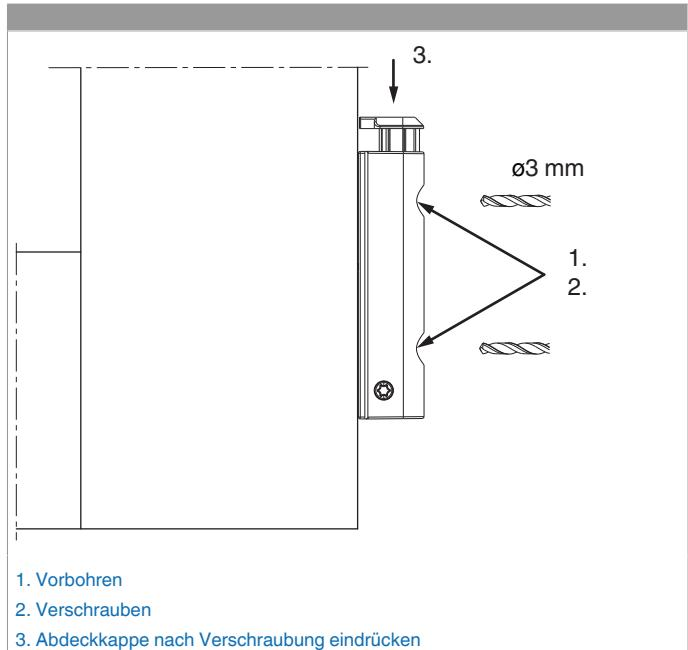
Das Ecklagerband DT mit ÜV an den Überschlag anlegen, die beiden Löcher am Überschlag vorbohren und verschrauben.
