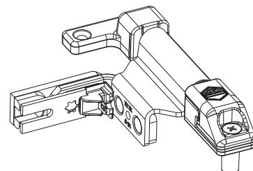
1. Scherenlagerstiftsicherung bis zum Anschlag aufschieben.
