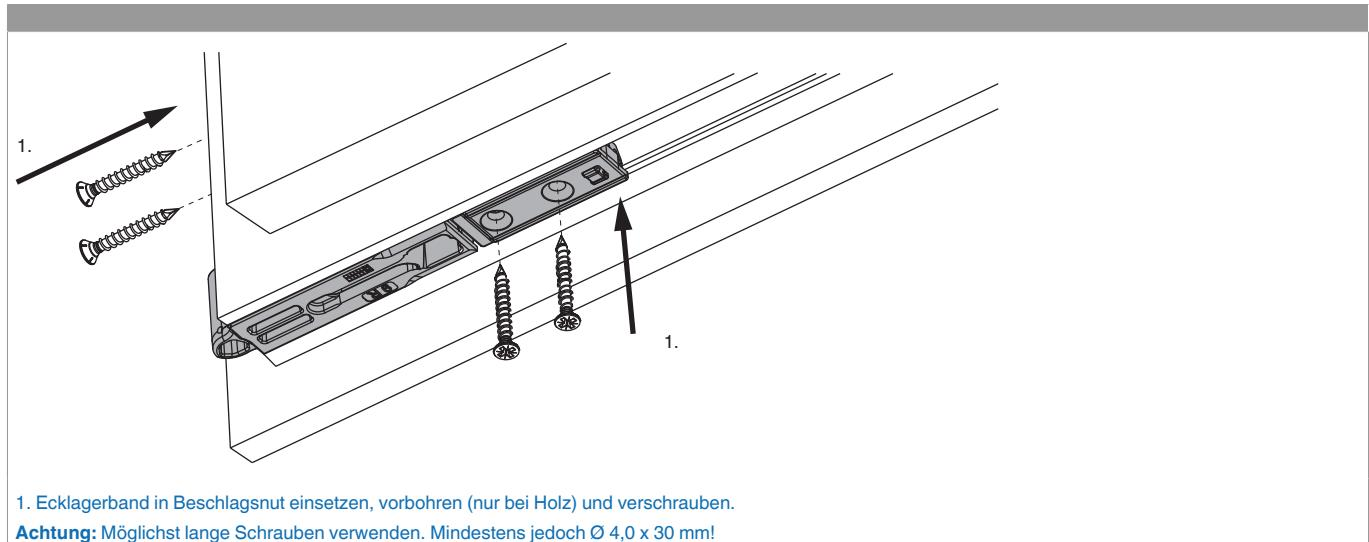
1. Ecklagerband in Beschlagsnut einsetzen, vorbohren (nur bei Holz) und verschrauben.
