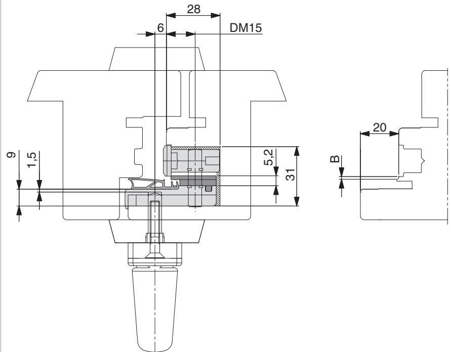
Einbauzeichnung zu Profil 12L-18Ü-9V mit großer Überschlagsdichtung, Abstand Beschriftungsnot 1 mm
