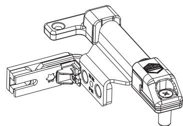
1. Scherenlagerstiftsicherung bis zum Anschlag aufschieben.
