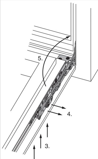
3. Flügel bandseitig nach oben anheben, bis Kippbandarm entlastet ist.
