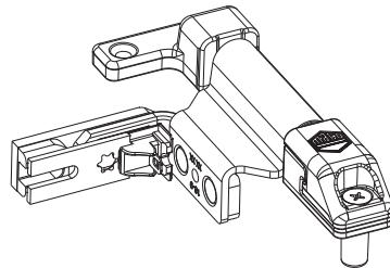
1. Scherenlagerstiftsicherung bis zum Anschlag aufschieben.
