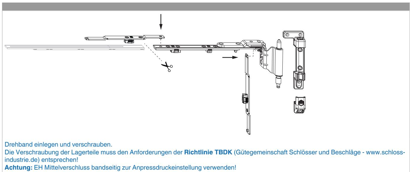
Drehband einlegen und verschrauben.
