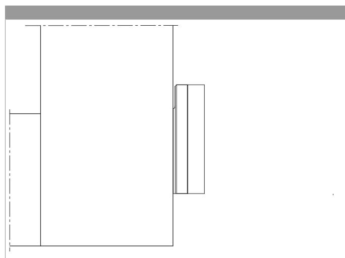
Das Ecklagerband in die Beschlagsnut legen und verschrauben!
