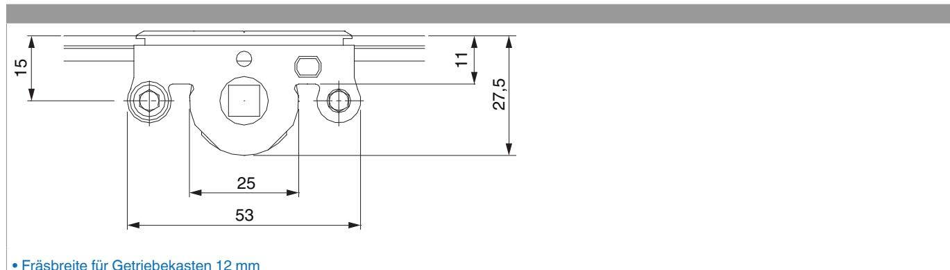
• Fräsbreite für Getriebekasten 12 mm
