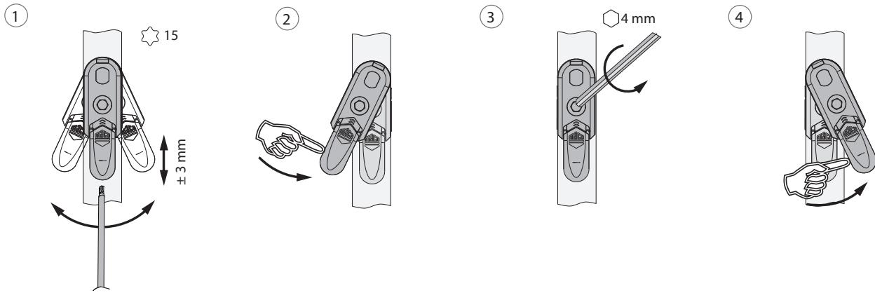
1. Ausschwenken und Höhenverstellung der Hebesicherung.
