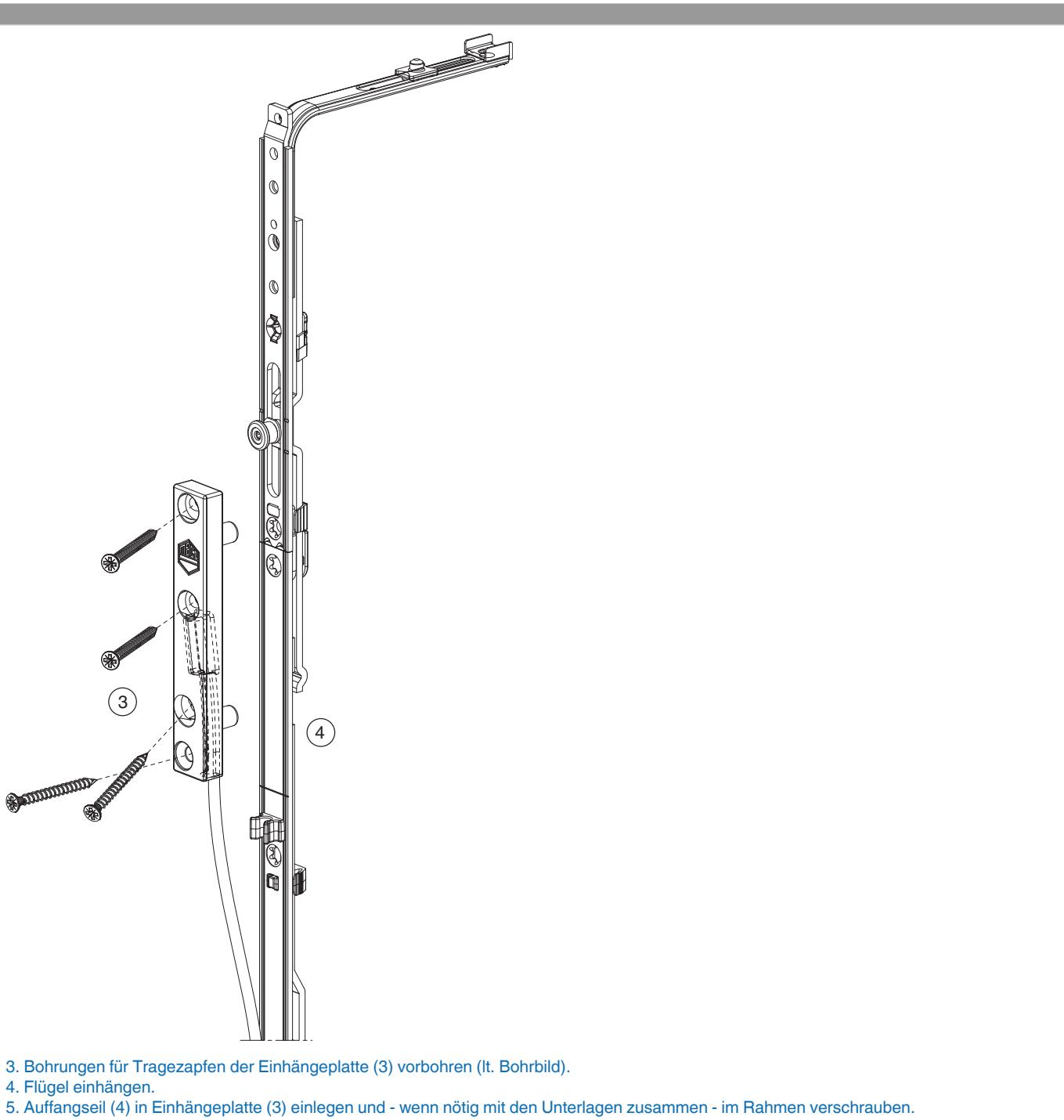
3. Bohrungen für Tragezapfen der Einhängeplatte (3) vorbohren (lt. Bohrbild).
