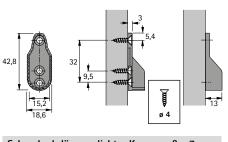
Schrankrohrlänge = lichtes Korpusmaß - 7 mm
