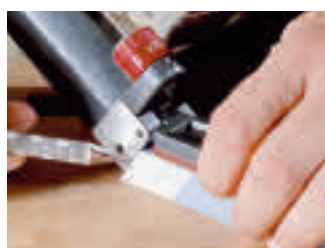
1. Fräsen und Mitte der Fräsung markieren
