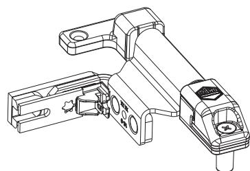
1. Scherenlagerstiftsicherung bis zum Anschlag aufschieben.
