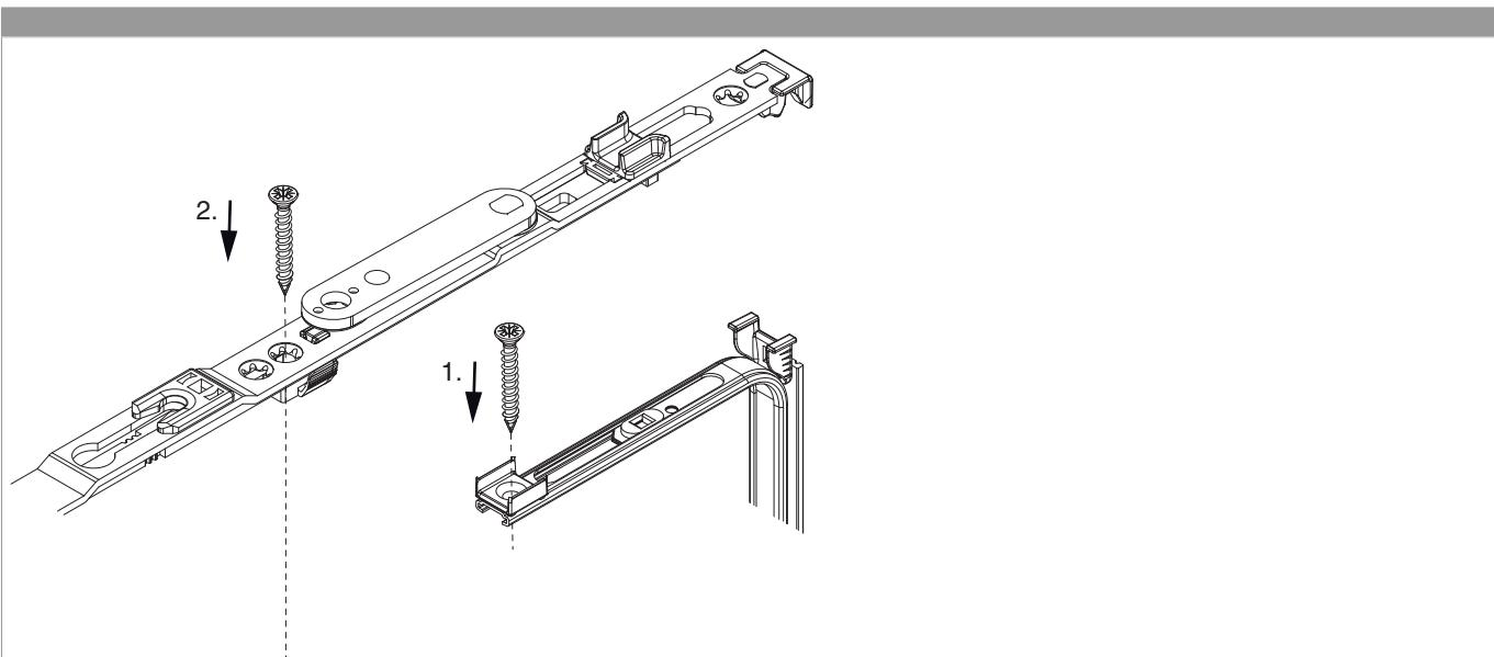
Zuerst Eckumlenkung senkrecht einsetzen und in den Nutgrund verschrauben (1), danach Scherenstulp in Eckumlenkung einklipsen und verschrauben (2).
