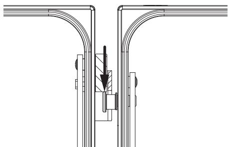
Wenn der Spreizhebel beim Einbruchsversuch von außen geöffnet werden soll, drückt der Sperrschieber auf den i.S. Zapfen und verhindert somit ein Öffnen.
