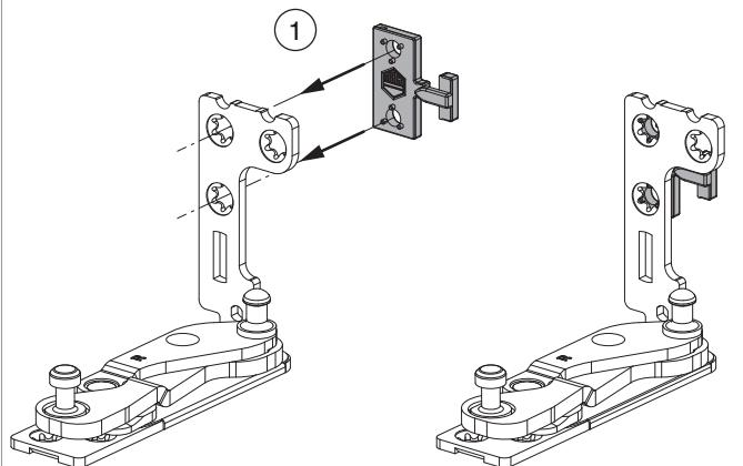
1. Senkrechten Teil der Unterlage abtrennen und auf den senkrechten Teil der Grundplatte des Ecklagers auf die inneren Bohrungen aufstecken.
