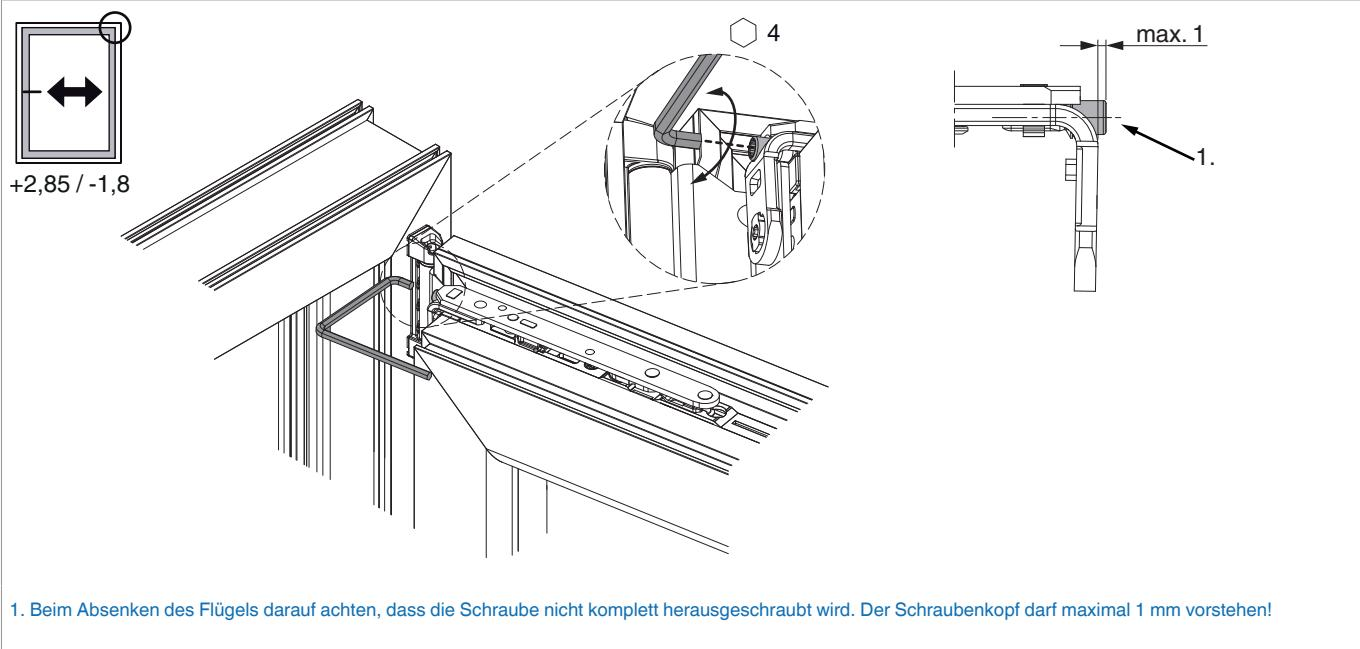
1. Beim Absenken des Flügels darauf achten, dass die Schraube nicht komplett herausgeschraubt wird. Der Schraubenkopf darf maximal 1 mm vorstehen!
