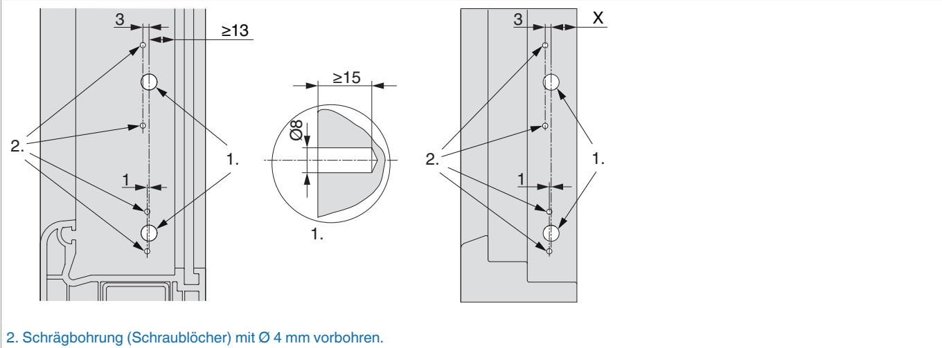
**2. Schrägbohrung (Schraublöcher) mit Ø 4 mm vorbohren.**
