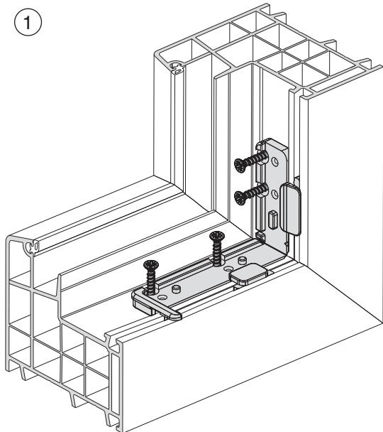
1. Zuerst Unterlage (lt. Profilblatt) mit PVC-Beschlagschraube mindestens 4 x 30 mm (Vollgewinde) verschrauben.
