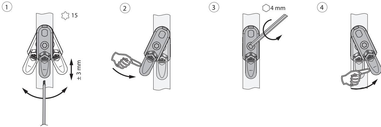
1. Ausschwenken und Höhenverstellung der Hebesicherung.
