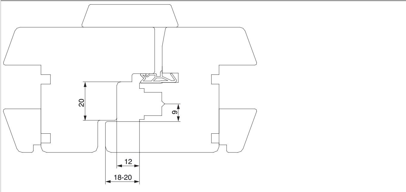
**Positionierung der Schließteile**
