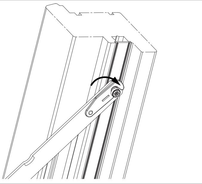
Der Einhängedorn **MUSS** mit einem Schraubloch vom Zentralverschluss mitgeschraubt werden.
