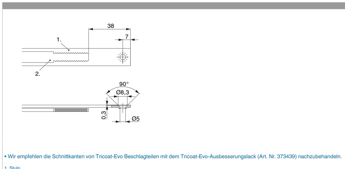
• Wir empfehlen die Schnittkanten von Tricoat-Evo Beschlagteilen mit dem Tricoat-Evo-Ausbesserungslack (Art. Nr. 373439) nachzubehandeln.
