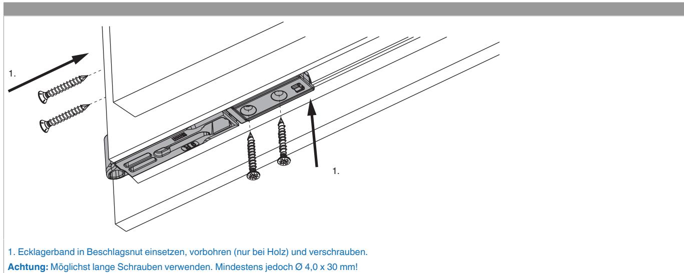
1. Ecklagerband in Beschlagsnut einsetzen, vorbohren (nur bei Holz) und verschrauben.
